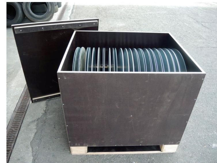
Mit den Packungseinheiten, die auf genormten Europalletten basieren, können Sie bis zu 20 Abdeckbleche einfach und sauber verpacken und auf die nächste Baustelle transportieren.
