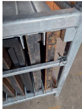
Auch die Sicherheit beim Transport oder Lagerung steht an erster Stelle. Darum verfügen die Transportrahmen über eine Verriegelungsvorrichtung, welches das Herausfallen auf dem Transporter oder im Lager verhindert.
